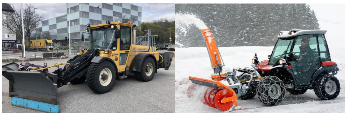
Figur 4 Exempel på underhållsfordon med vikt ca 3,5 – 4 ton
