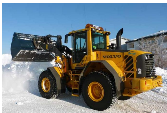
Figur 3 Exempel på underhållsfordon med vikt ca 12 ton
